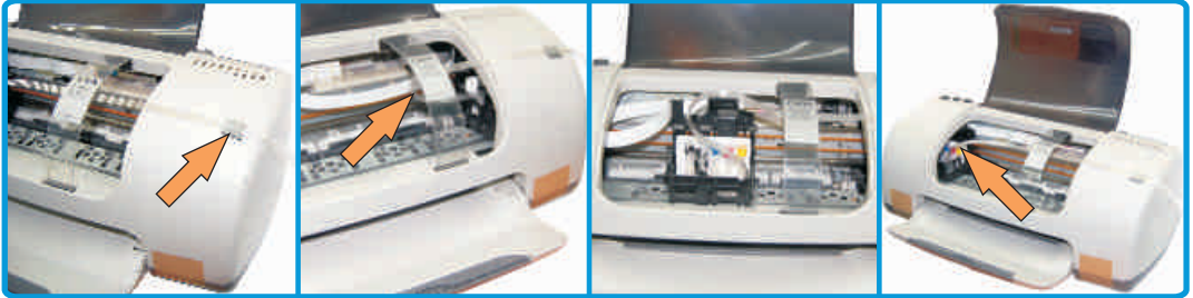
Прокладка шлейфа С62
