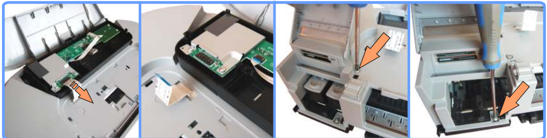
Снятие панели управления iP6210D
