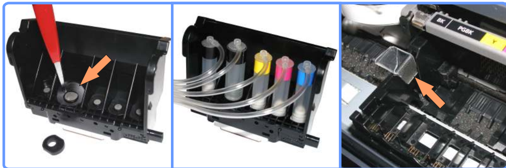
Подготовка печатающей головки iP4500
