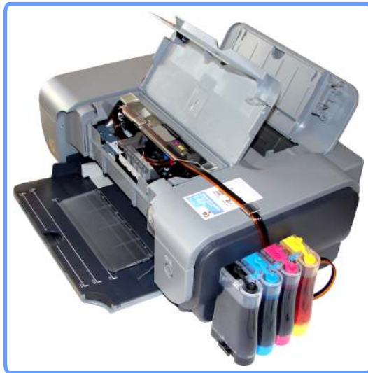
Установленная система iP3300
