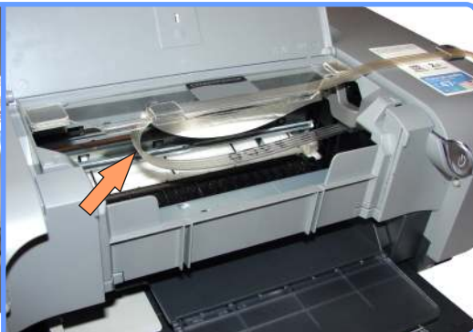
Установка картриджей iP3300
