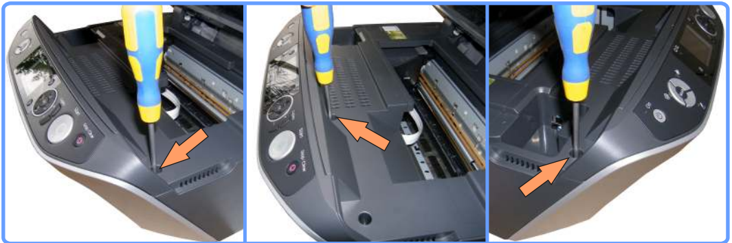
Удаление крепёжных болтов RX590
