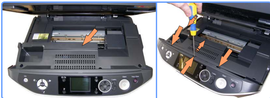
Снятие панели RX590
