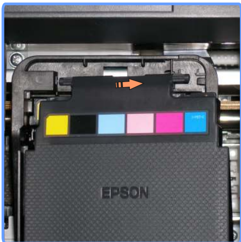
Удаление крышки картриджного отсека R390
