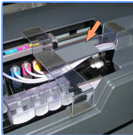
Установка планки-фиксатора MP510
