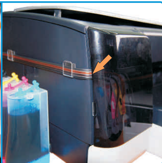
Установка фиксатора крышки K8600
