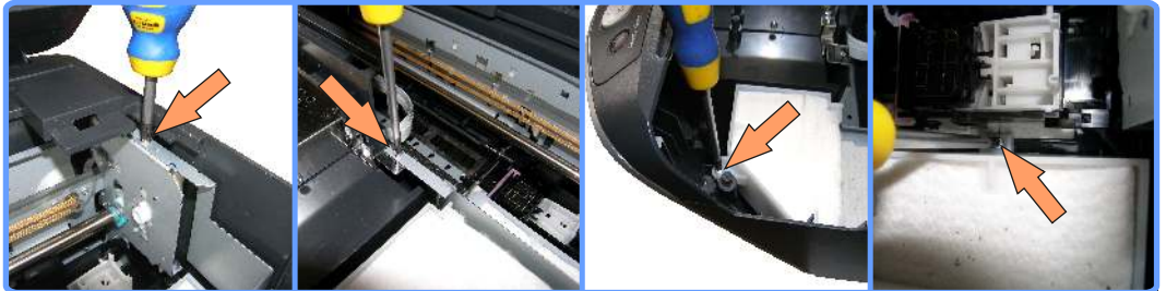
Удаление крепёжных болтов RX590
