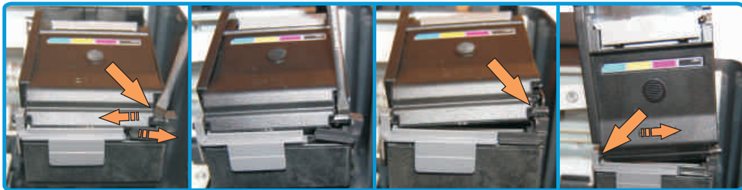
Снятие крышки картриджного отсека CX4300
