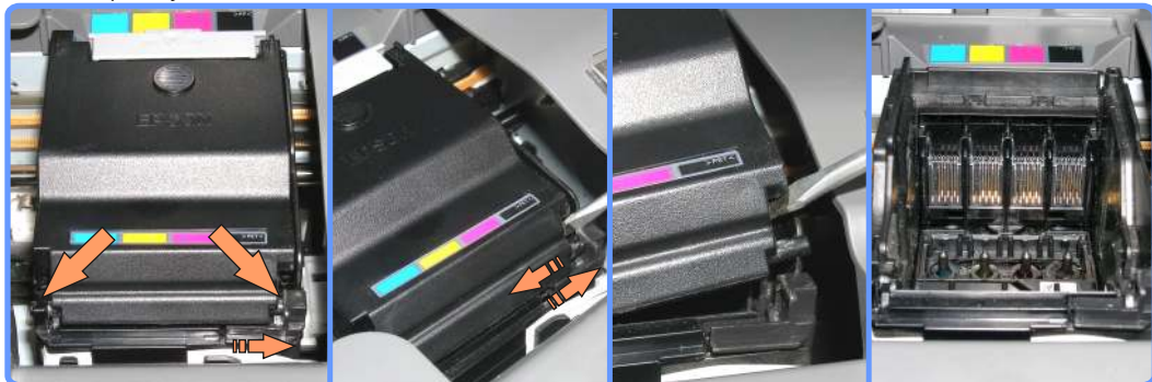
Снятие крышки картриджного отсека CX3900
