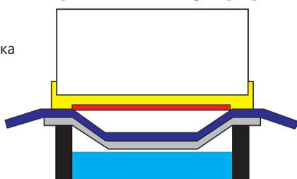
Жесткость пластины должна быть такой, чтобы она прижимала промокашку, пропитанную промывочной жидкостью, к пластине дюз.
