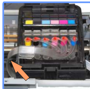
Прокладка шлейфа R270
