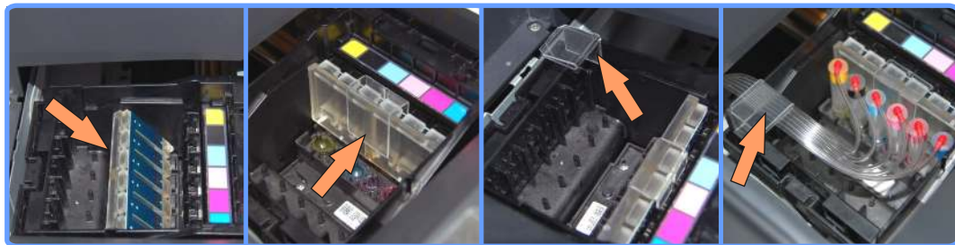
Установка капсул и планки с чипами R270
