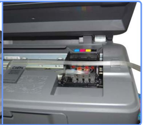
Прокладка шлейфа CX4900
