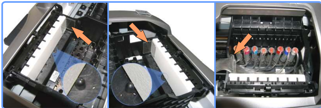
Установка капсул и планки с чипами R800
