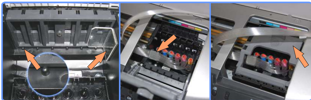
Установка капсул и планки с чипами R340
